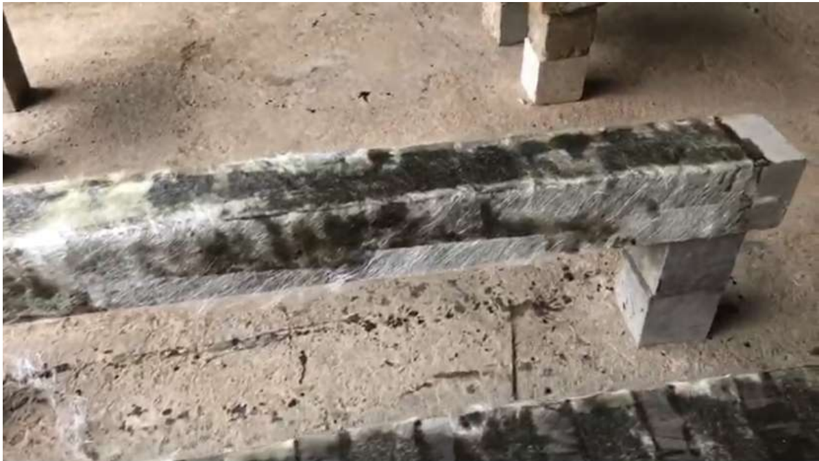
3.2: iiU iiwrapping iusing iiglass iifiber iisheets
